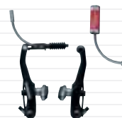
МОДУЛЯТОР УСИЛИЯ (SM-PM40) и V-BRAKE
